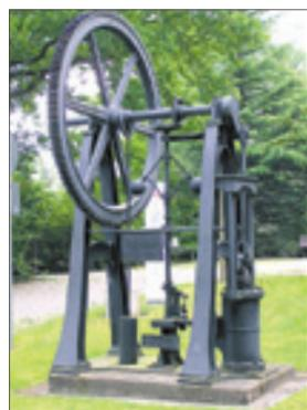
Das Foto zeigt eine so genannte **Bockdampfmaschine** mit Fliehkraftregler der Maschinenfabrik „Klett & Comp.“. Sie datiert auf das Jahr 1850 und hatte eine Leistung von 10 PS. Heute befindet sich die historische Anlage auf dem ehemaligen MAN-Gelände in Nürnberg. (Foto: L. Kenzel)
