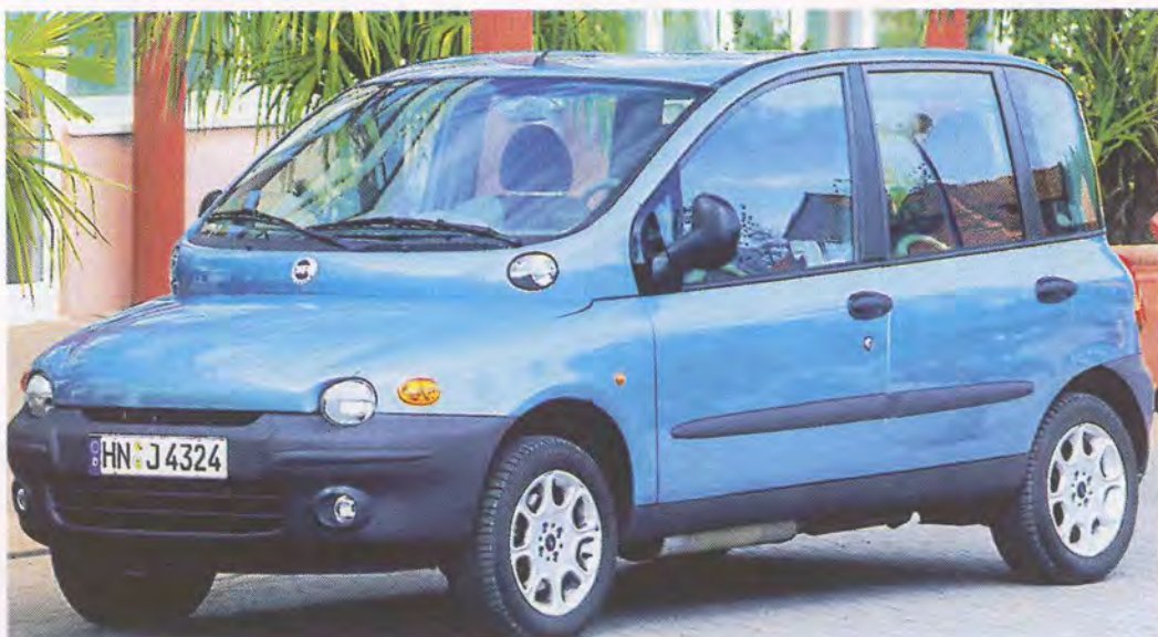
Mit dem Multipla Bipower von Fiat steht ein alltagstaugliches bivalentes Fahrzeug zur Verfügung.
