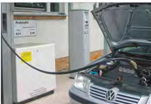
Als Sonderanfertigung kann man die Betankung auch im Betankungstutzen im Motorraum durchführen. Regelmäßig wird aber der Tankstutzen außen in der Nähe des Benzinbetankungstutzens angebracht.
